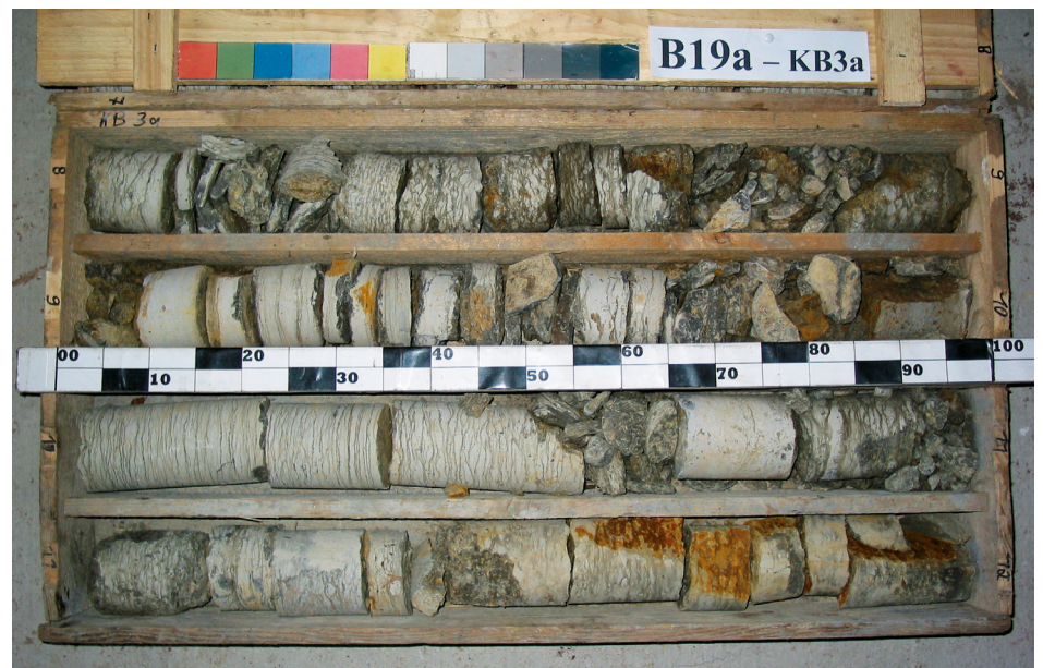
In-situ-Beprobung durch Bohrkernentnahme. Die Probenentnahme vor Ort (in-situ) wird zur Untersuchung von schadstoffbelasteten Böden durchgeführt. © Autobahndirektion Nordbayern
