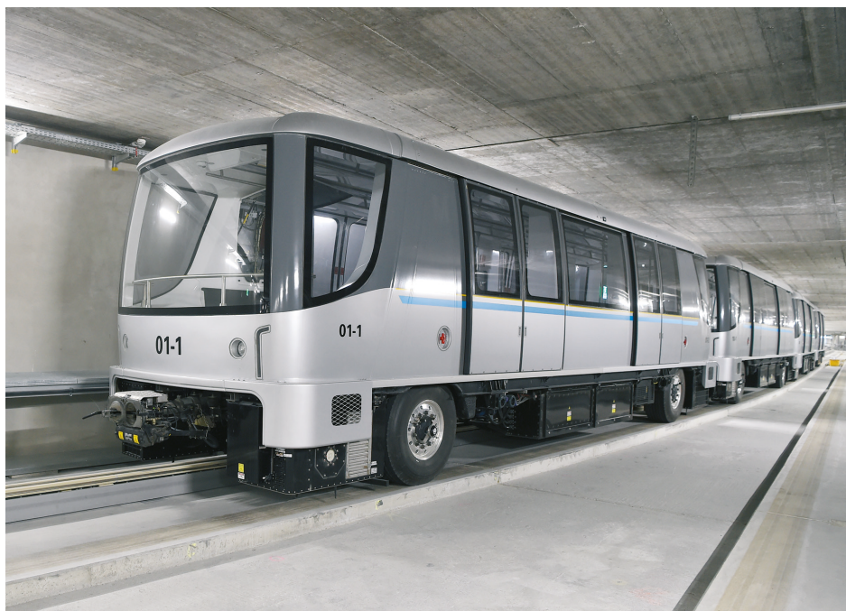
Der vollautomatische PTS-Zug bewegt sich auf gummibereiften Rädern. Eine in der Mitte verlaufende Schiene versorgt die Bahn mit Strom. © Flughafen München
